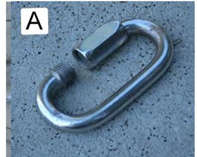
6.3.5 a) はリードの支点（スピードのトップロープ支点も含む）についての規定です。まず、クイックドロウの支点（ハンガー）側には、カラビナではなく「クイックリンク」（写真 A）を使用」とあります。クイックリンクはこれまでずっとフランス語の「マイロンラピッド」でしたが、2013 年に英語のクイックリンクに変わり、マイロンラピッドはカッコ書きで併記されるようになりました。用具類の名称は今日では英語に統一されているのでそれに合わせたのでしょう。
